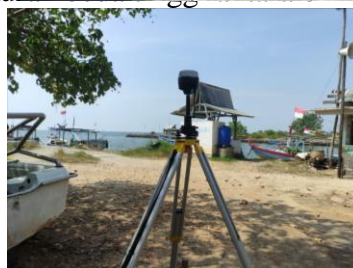
Gambar 5 Pengukuran posisi koordinat bm dengan gps geodetik Emlid RS2+
